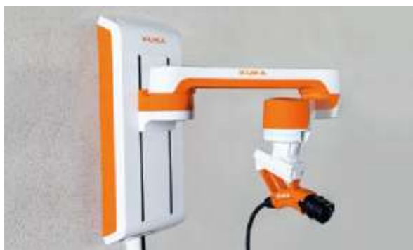
Stația de andocare complet automată de încărcare a bateriei se bazează pe asistentul de încărcare KUKA cu tehnologia carla_connect
